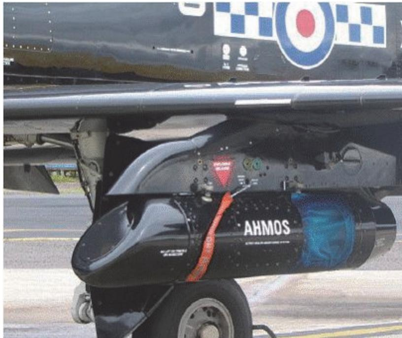
図 2.2.2 (3) - 1 T1A に搭載したセンサーシステム
