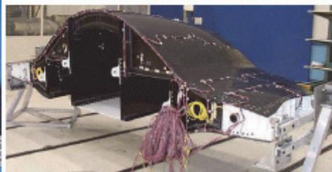
図 1.4.3 (4) - 4 π Joint 構造供試体
