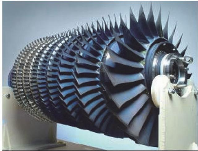
図 2.1.2 (8) - 5 E 3 E Blisk 段と TiAl Blade 段
